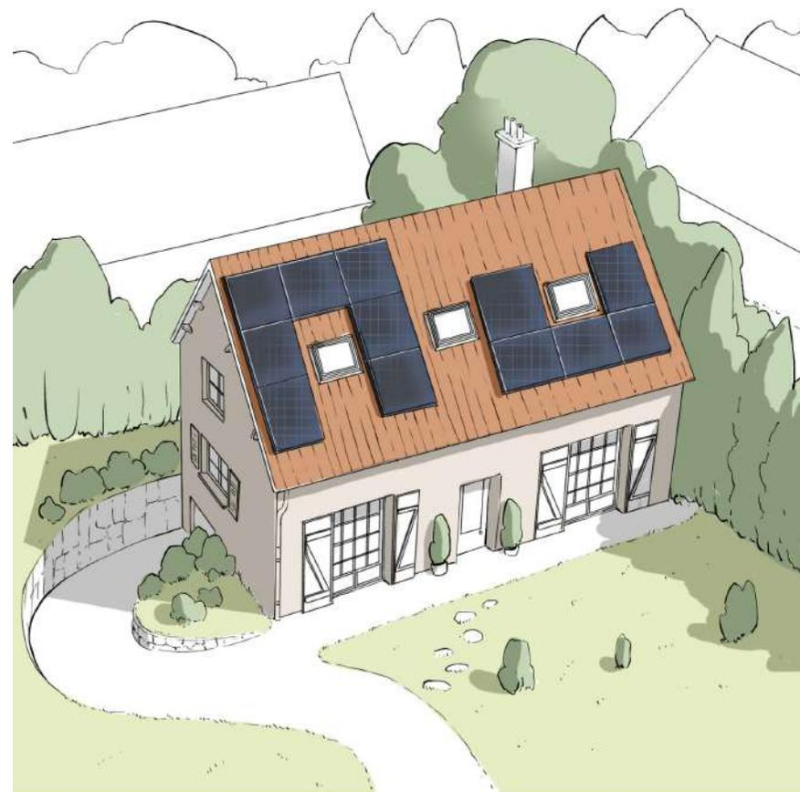
La position des panneaux sur le toit doit **éviter le déséquilibre et l'organisation chaotique**. Il faut éviter de laisser apparaître des bandes étroites et de diverses largeurs du matériau de couverture sous-jacentes surtout si elles occasionnent un contraste de couleurs.
