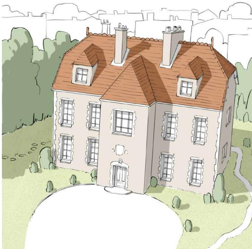
Les **toitures riches de modénatures** animées ne peuvent pas s'encombrer en plus de panneaux photovoltaïques. Ainsi, si votre toit porte d'élégantes lucarnes, une croupe orientée vers la pluie dominante, des cheminées massives ... alors il ne peut pas accueillir, en plus, une production photovoltaïque.
