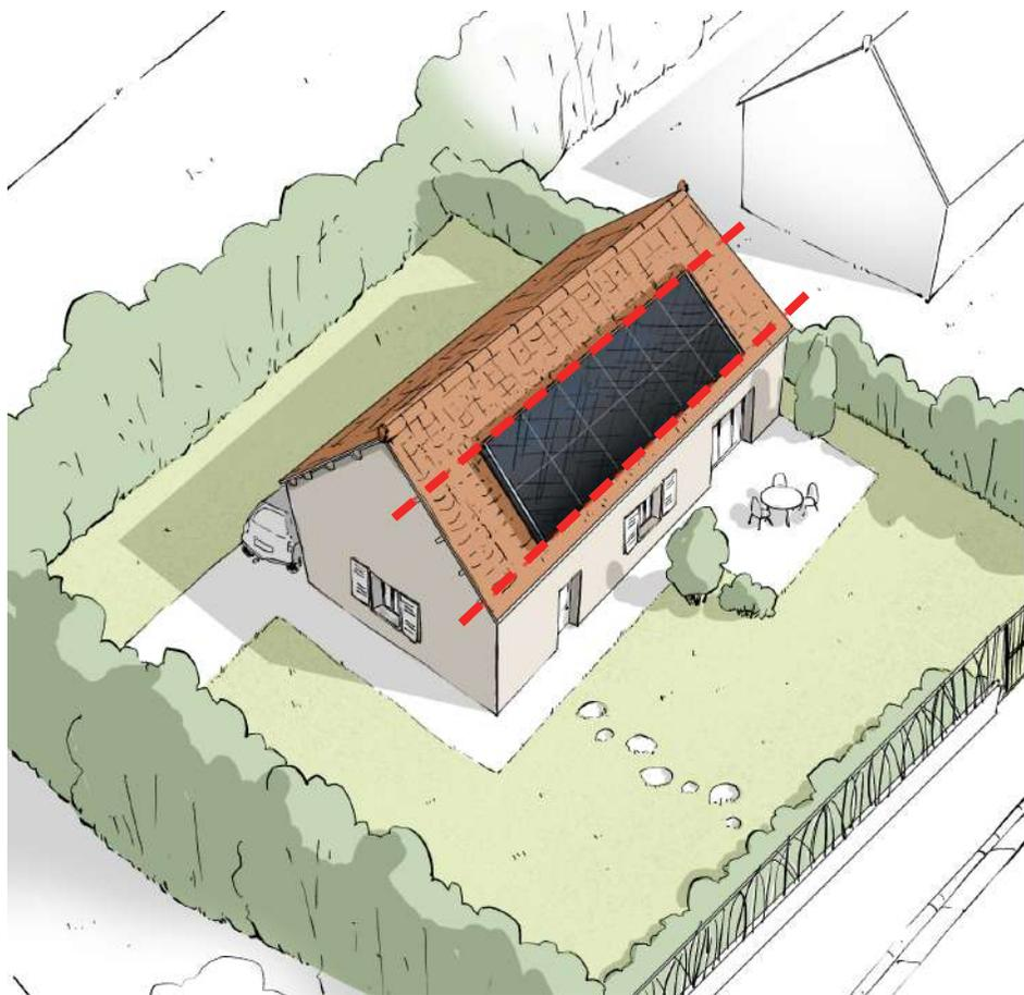
Le haut des panneaux doit être implanté **parallèlement à la ligne de faîtage** et/ou à l'égout. Les panneaux doivent être, préférentiellement descendus vers la partie basse du toit pour dégager la dominance du faîtage. Ils sont installés parallèlement à la pente du toit.
