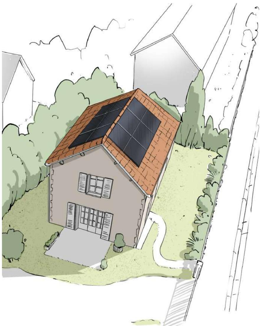
Lorsque l'orientation le permet, la **position zénithale sur les deux pans** de la toiture, façon verrière, est une formule possible. Cette disposition doit préserver la continuité du faîtage.
