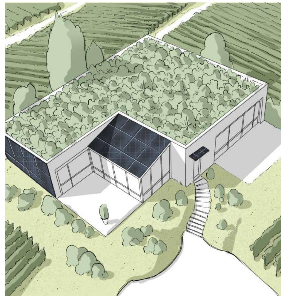
Notamment **sur les constructions neuves, les panneaux peuvent aussi s'imaginer en façade ou en applique**. Ils peuvent alors assurer une fonction complémentaire à celle de la production d'électricité. Les panneaux peuvent effectivement servir de pare-soleil, couvrir une véranda, abriter un auvent, constituer une marquise pour protéger une entrée ou encore en accompagner un garde-corps
