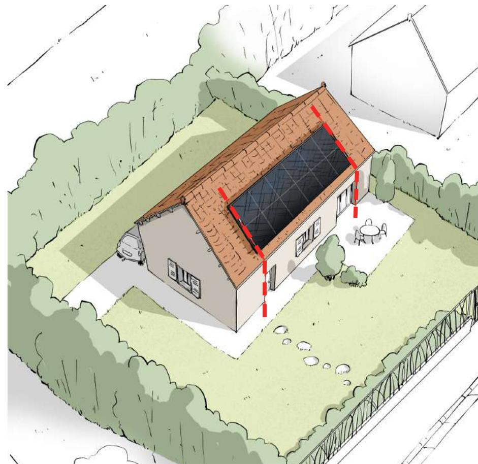
Les panneaux doivent **s'aligner avec les percements de la façade**. La composition doit être cohérente et harmonieuse, respectueuse de la symétrie de la façade lorsqu'elle existe. Les équilibres de proportion entre la toiture et les panneaux doivent rappeler les équilibres entre les baies de percement et les maçonneries de la façade.
