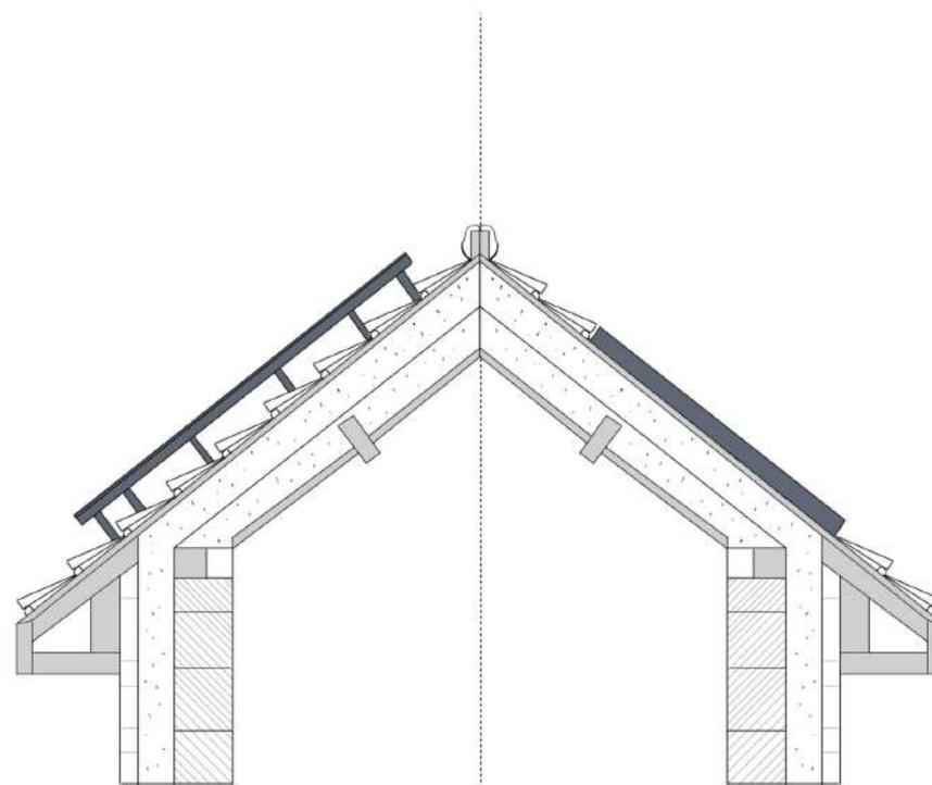
La mise en place des panneaux doit, de préférence, **suivre rigoureusement la pente du toit en position affleurante** (notamment dans le cas de constructions neuves ou de rénovations complète de la toiture). La position surimposée est souvent une réponse technique. Elle doit alors rechercher un profil le plus bas possible et s'accompagner d'un traitement très intégré des rives de panneaux ; profilé discrets et mats, de même couleur que les panneaux.
